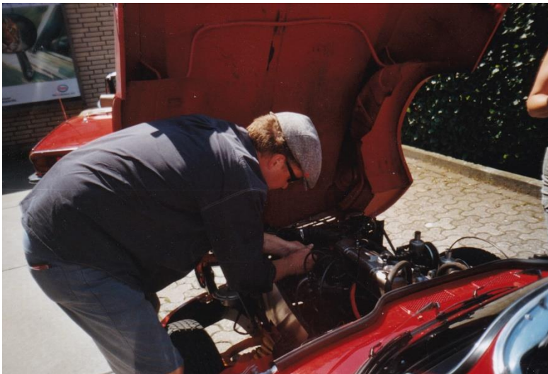
Verdammt: Ärger mit der Halterung der Lichtmaschine
